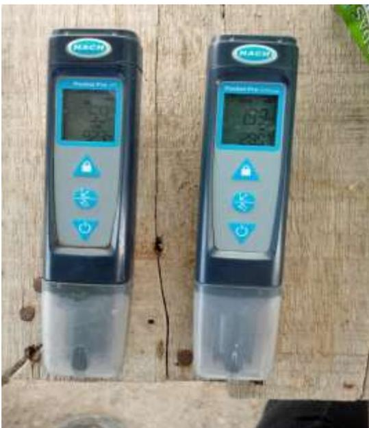
Foto N°4 Peachímetro y conductímetro
