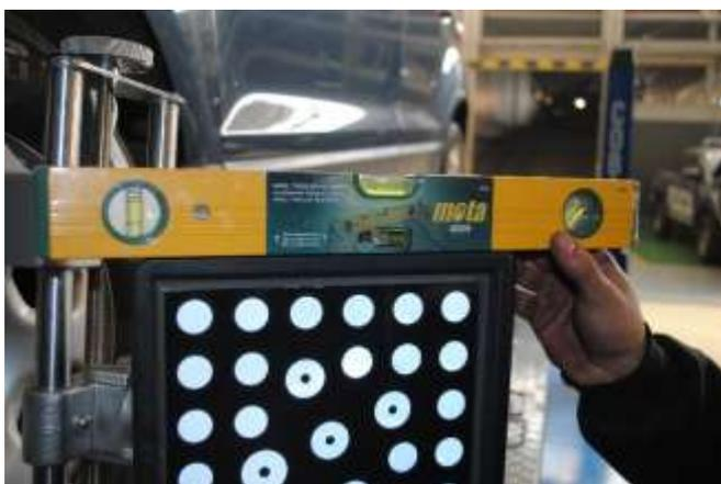
Imagen 21 - Nivelador en posición recta horizontal, indicando correcta ubicación de la cámara, Goldstein Automotores
