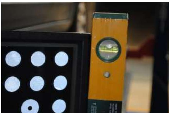
Imagen 20 - Nivelador en posición recta vertical, indicando correcta ubicación de la cámara, Goldstein Automotores
