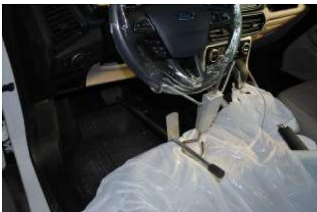
Imagen 18 - Depresor de freno con traba de volante colocada, Goldstein Automotores
