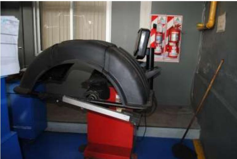
Imagen 11 - Balancadora John Card con tapa en posición de trabajo
