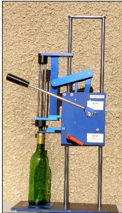
Figura 2.8: Dispositivo Orbisphere n° 29973 para la extracción de la muestra en botellas (foto Maza 2004).
