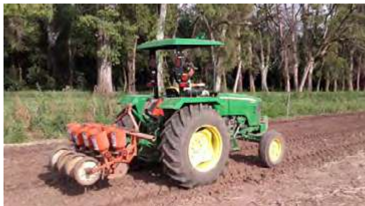
Figura 2. Tractor con sembradora hortícola sembrando el perímetro del lote con una mezcla de semillas hortícolas y forrajeras para establecer un borde de biodiversidad.
