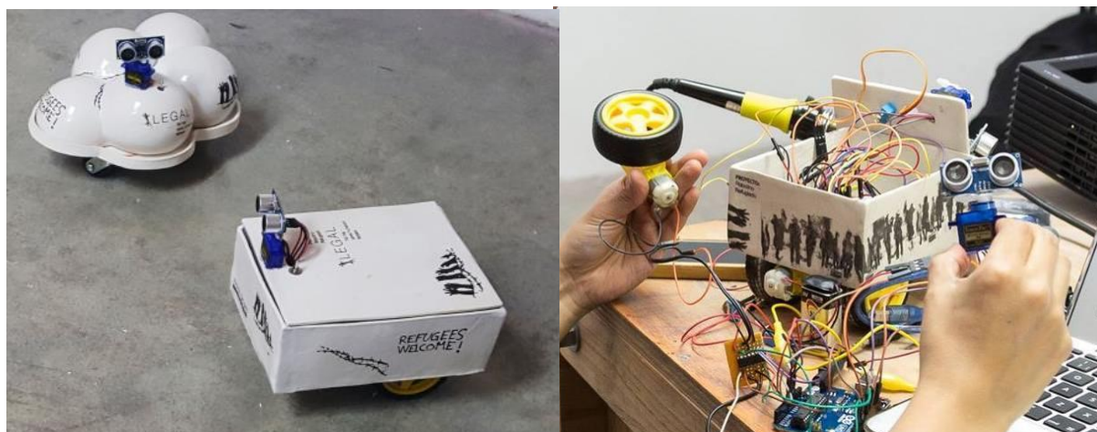
Ilustración 103. Izquierda: Robotinos en funcionamiento, transitando en una muestra artística entre el público. Derecho: integrante de la investigación construyendo la conexión electrónica del Robotino y testeando su funcionamiento.
