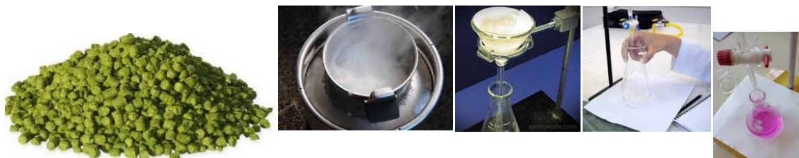
Figura 1. Secuencia de procedimiento de análisis de lúpulo para cuantificar alfa-ácidos
