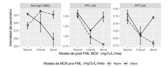
Figura 3.7: Efectos de interacción: para vinos Cabernet Sauvignon provenientes de Oakville, 2014. Vinos sometidos a diferentes niveles de post-FML MOX (0 mg O2/L/mes, 4.5 mg O2/L/mes y 9 mg O2/L/mes) con y sin pre-FML MOX (20 mg O2/L/mes).
