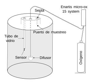
Figura 2.3: Sistema experimental de suministro y medición de oxígeno (MOX), y puerto de muestreo de vino
