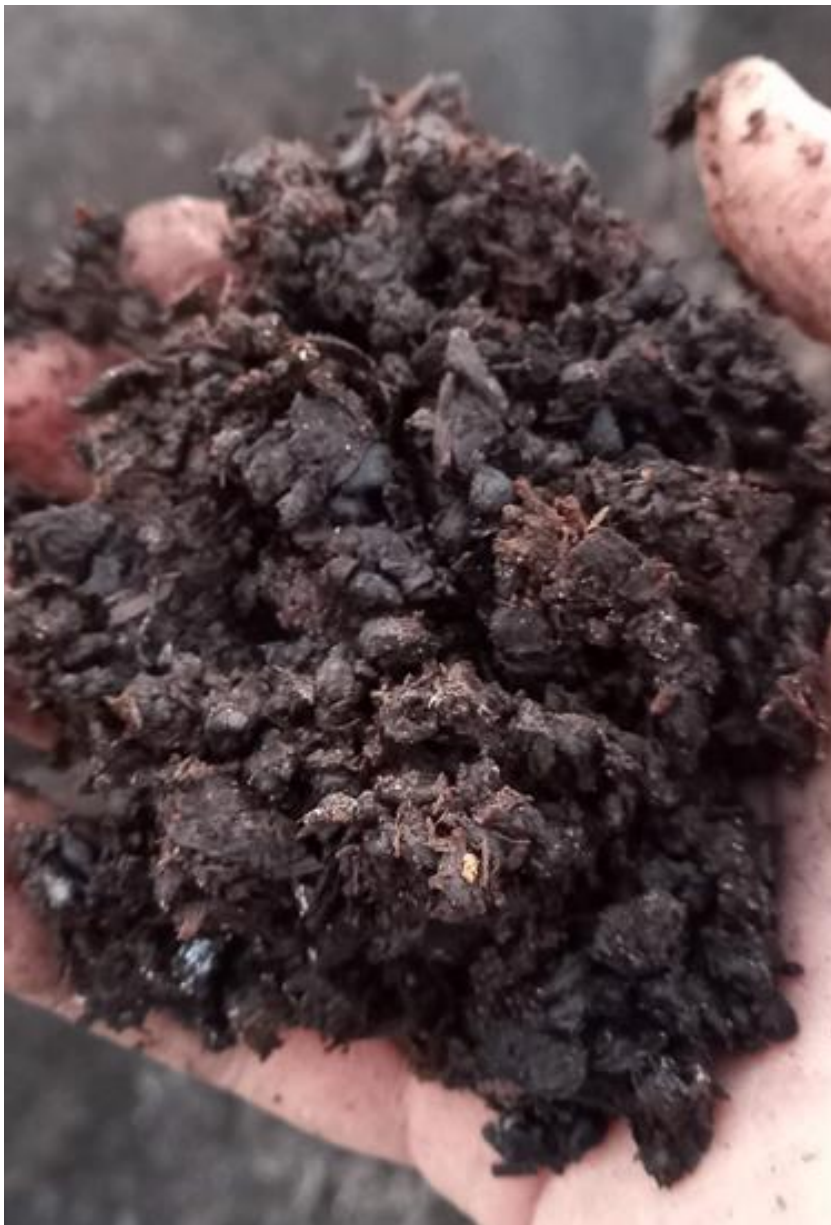
Figura 17.19: Compost obtenido de la sección cercano a la superficie de la pila con aireación estática al finalizar el procedimiento de compostaje. A simple vista puede notarse que la acción degradativa de los microorganismos en las pilas de aireación estática no fue suficiente para generar un material homogéneo en el lapso de 89 días. Fuente: Imagen propia, tomada el 10 de junio de 2025.
