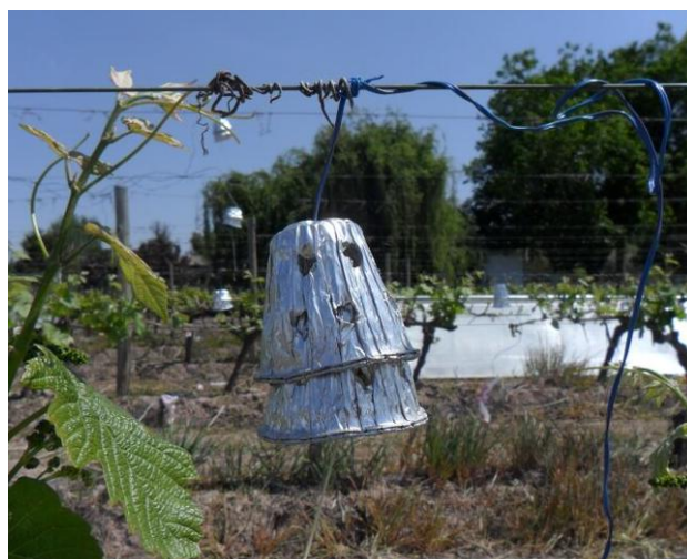
Figura 2.3: Termocuplas de medición de temperatura de aire con abrigo de protección de la radiación solar.
