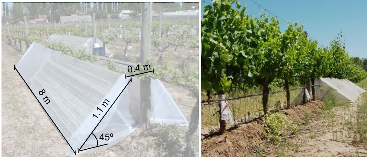
Figura 2.2: Sistema de calentamiento pasivo (SCP) en parcelas de Syrah en brotación (izquierda) y Grenache en envero (derecha). Estación Experimental Agropecuaria Mendoza, INTA.
