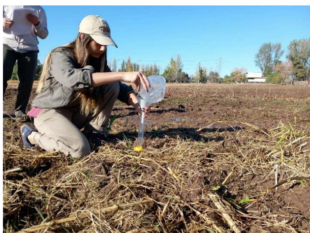
Foto N°2: ejecución de las mediciones de los colectores para el cálculo de los coeficientes de uniformidad.
