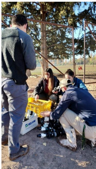
Foto N° 3: ejecución de las mediciones de los colectores para el cálculo de los coeficientes de uniformidad.
