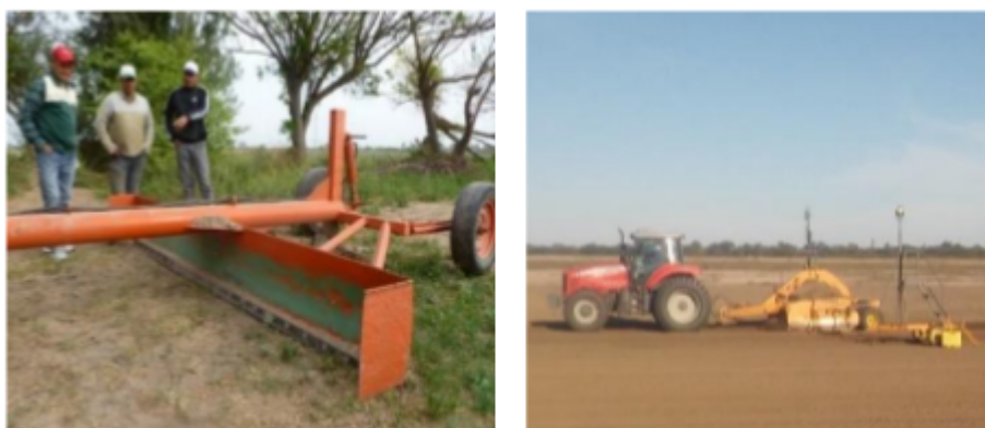
Figura 3- a la izquierda, niveleta hecha por el grupo de productores, a la derecha nivelación con pala y equipo laser
