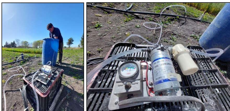
Figura 1- Dilución de dosis de urea en tanque fertilizador e inyección con bomba fertilizadora.
