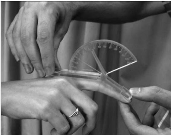
Otra variante de goniómetro que se ha desarrollado en esta investigación, combina la acción de dos aparatos, para facilitar la determinación de los valores angulares en segmentos corporales ubicados en serie, como el conjunto brazo/antebrazo/mano. Este instrumento posee dos círculos de plancha de acrílico transparente,
