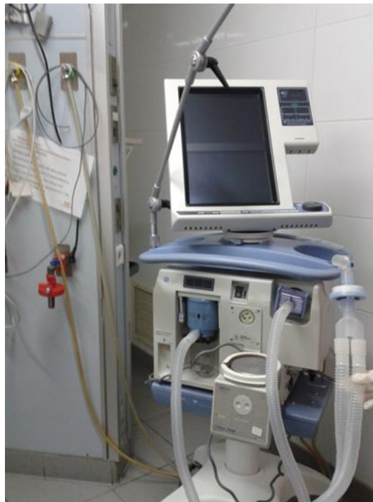
Figura 3. Visión de la tubuladura conectada a un humidificador.
